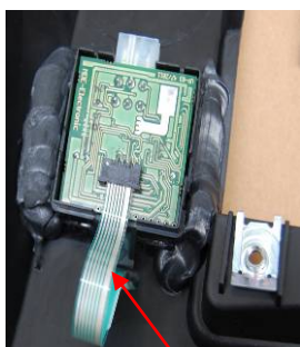
4 Leiterbahn der Folientastatur
