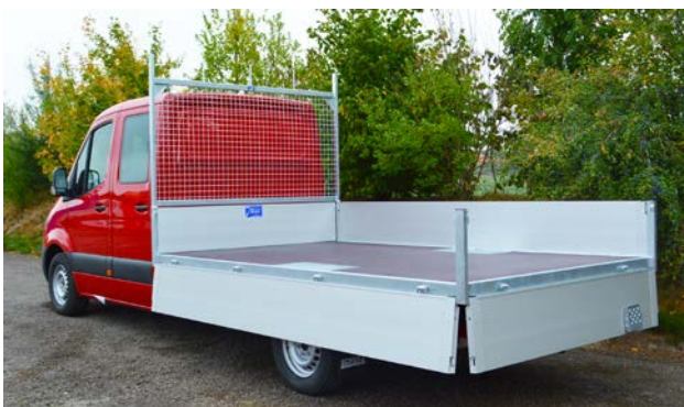
Abb. Stirnwandschutzgitter mit integriertem Leiteraufsatz. Nur ungleichmäßige Beladung möglich!
