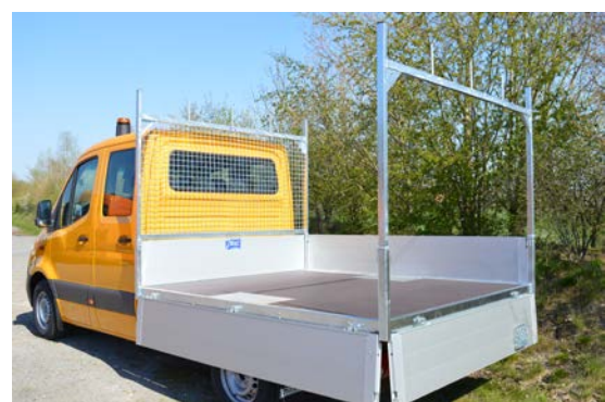
Abb. Stirnwandschutzgitter mit integriertem Leiteraufsatz sowie Leiteraufsatz hinten. Gleichmäßige Beladung möglich!
