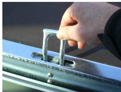
Die Zurrösen sind im Außenrahmen eingelassen und werden zum Verzurren der Ladung herausgezogen.
