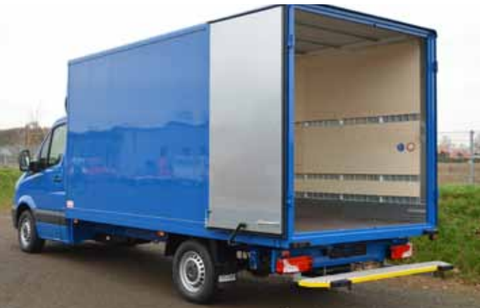
Ausführung Aluminium Bauweise mit breitem Heckauftritt.
