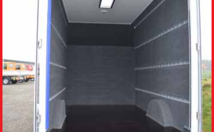
Ausführung mit Nadelfilz-Innenauskleidung.
