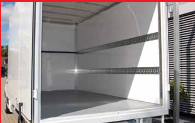
Ausführung mit GFK-Boden und versenkten Kombizurrschienen.
