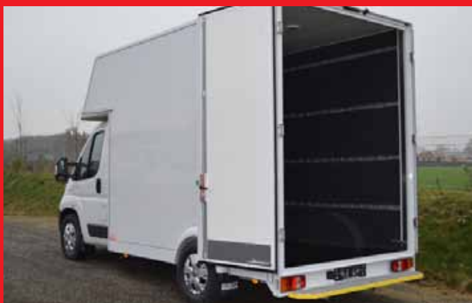
Ausführung mit 2 Reihen Stab-Zurrleisten versenkt.
