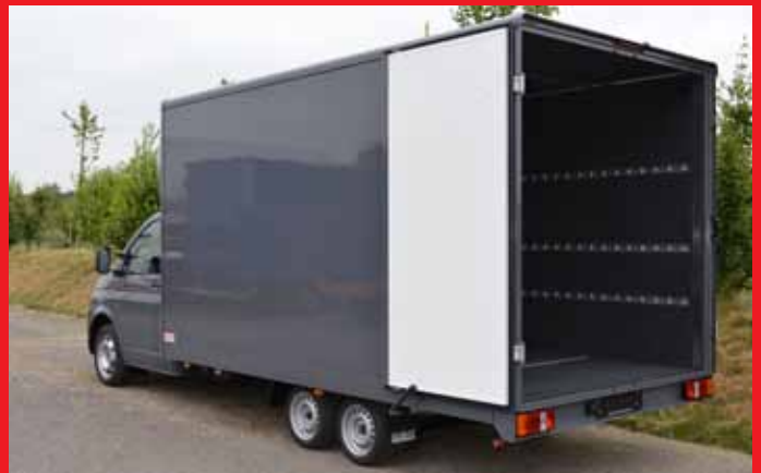
Ausführung mit Nadelfilz-Innenauskleidung..
