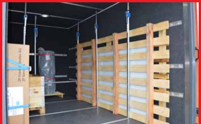
Ausführung mit Boden-Deckenarretierung
