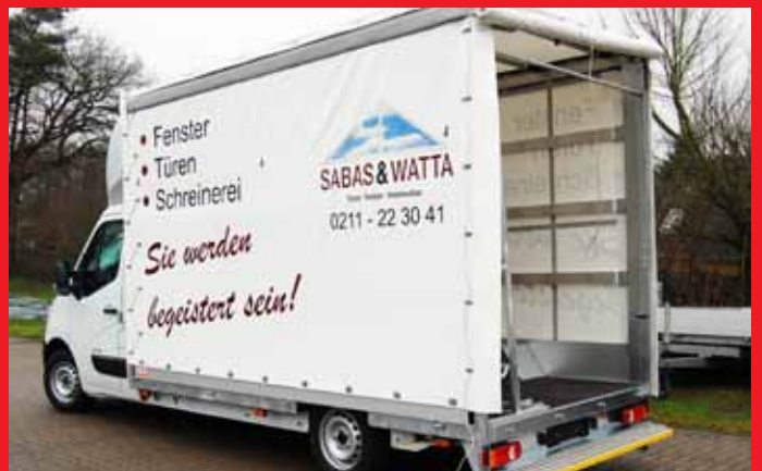
Pritschenausführung mit möglicher Seitenbeladung.
