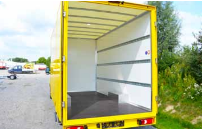
Ausführung mit 3 Reihen Stab-Zurrleisten versenkt.
