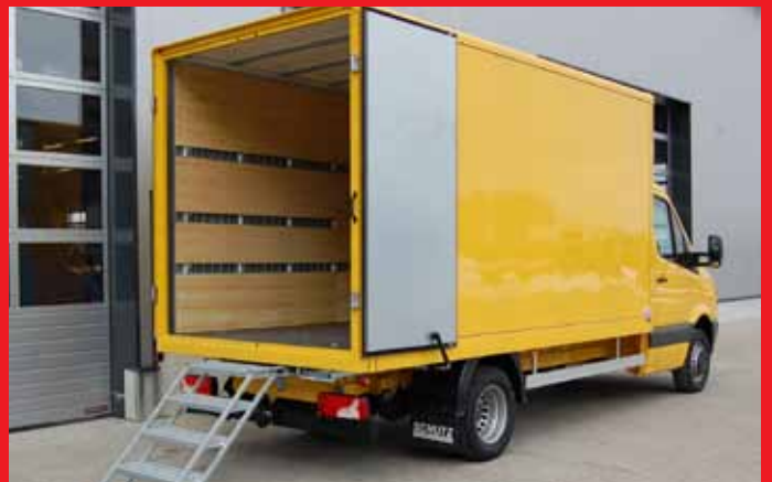
Ausführung Aluminium Bauweise und ausziehbarer Hecktreppe.
