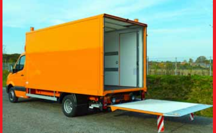
Ausführung mit hydraulischer 1000 kg Ladebordwand.
