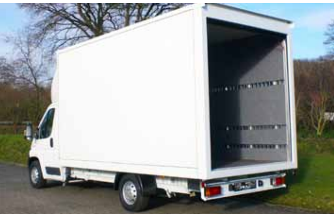
Ausführung mit Heckrolltor und Nadelfilzauskleidung.
