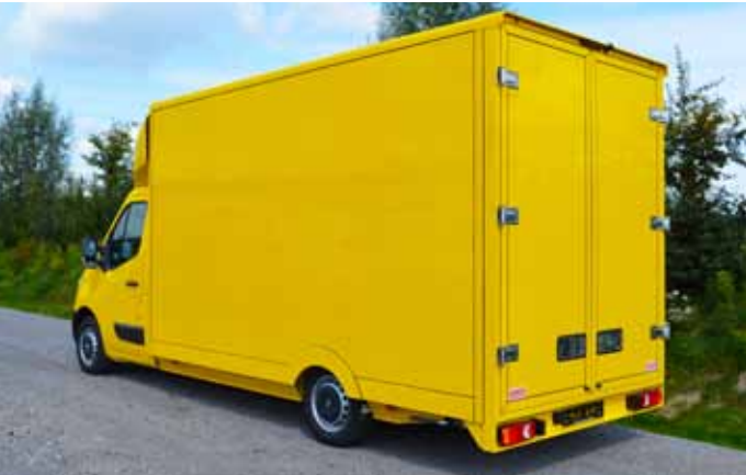
Ausführung mit Aluminium-Portal und Sandwich-Hecktüren.
