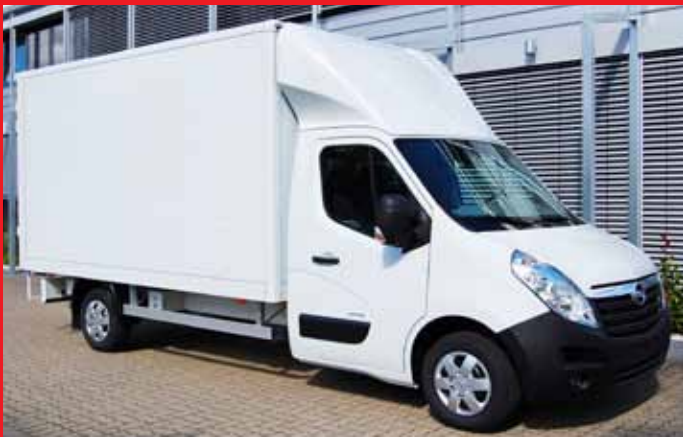
3500 kg leichtbau Sandwichkoffer mit Aluminium Hilfsrahmen.
