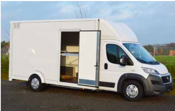
Ausführung mit Seitentür und Verschluss mit Innendrücker.
