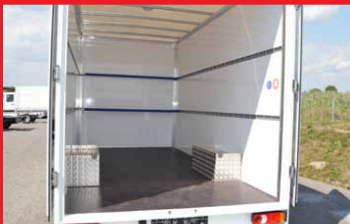
Ausführung mit 2 Reihen Stab-Zurrleisten versenkt.
