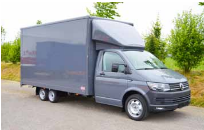
Ausführung mit 13"-Chassis ohne inneren Radkästen.
