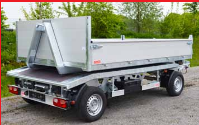
Schutz Absetzpritsche mit 4000 mm Gesamtlänge.
