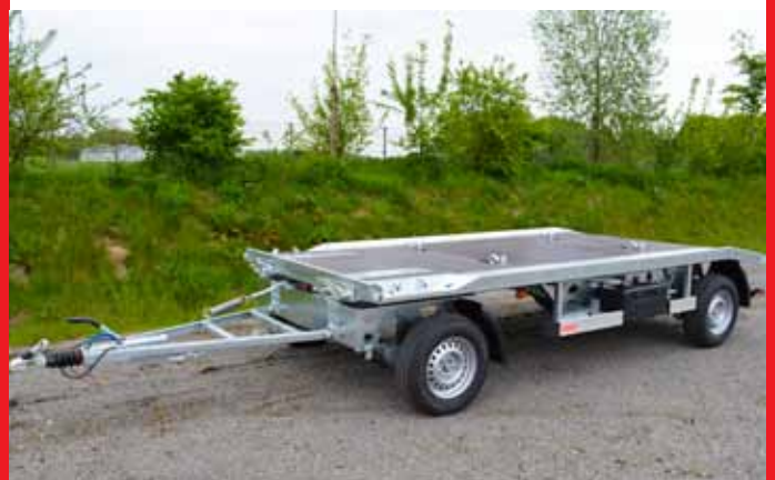
Stabile und komplett feuerverzinkte Stahl-Leichtbauweise.
