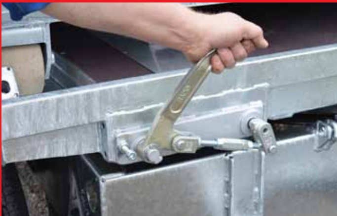
Einfaches Verriegeln der Mulden mit Übertotpunktspanner.
