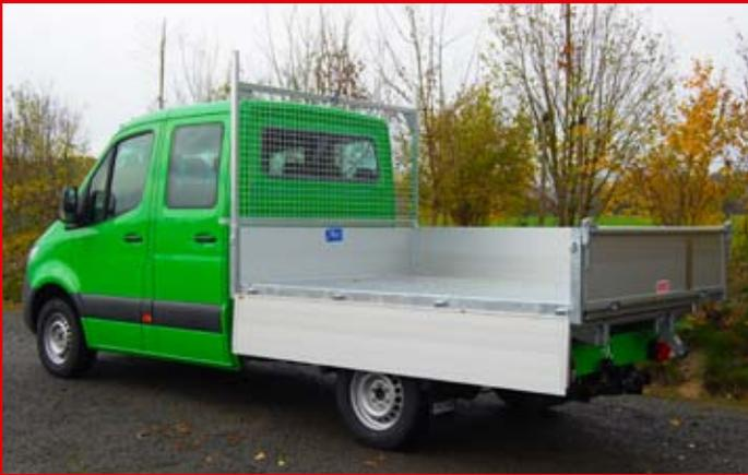
Verstärkte Aluminium Kipperbordwände mit oberer Kante.
