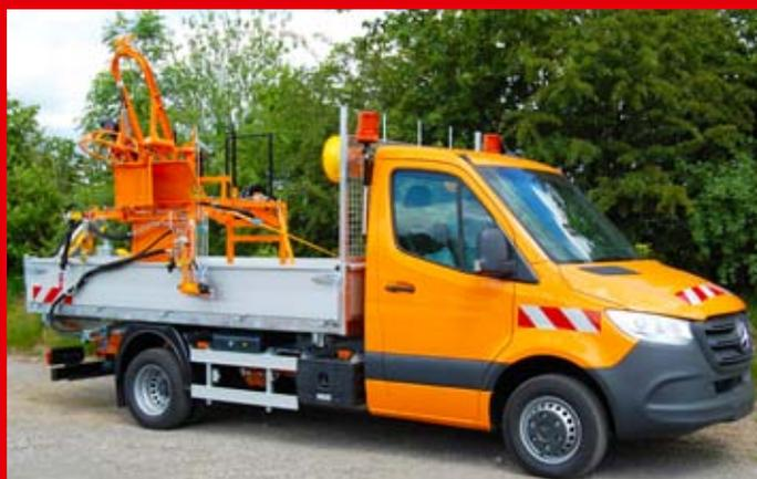
Ausführung mit Umbau für Schmalz-Sinkkastenreiniger.
