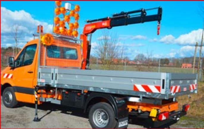
Teleskopkran M 25 auf Schutz Mittelhochpritsche montiert.
