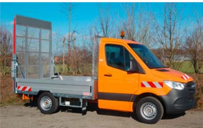
Ausführung mit Gitter-Auffahrrampe für 1.000 kg Tragkraft.
