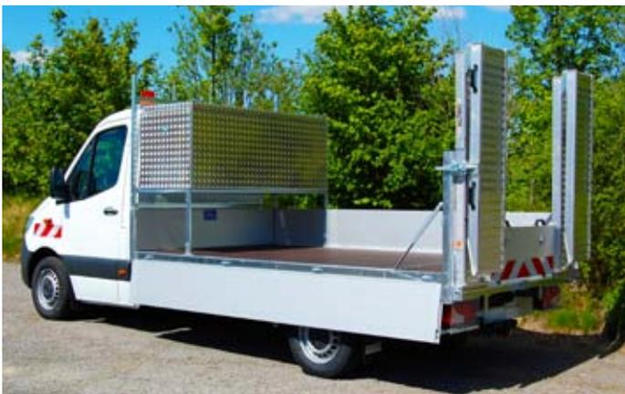
Ausführung mit erhöhter Werkzeugbox und Auffahrschienen.
