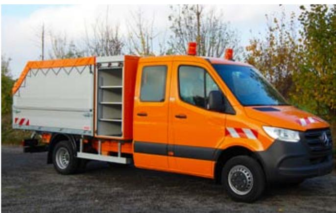
Ausführung mit Materialkasten, Häckselaufsatz und RKL.
