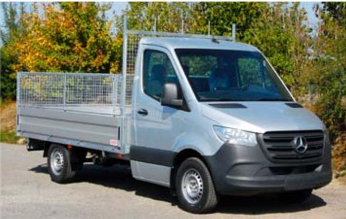
Ausführung mit Stirnwandgitter und 600 mm Gitteraufsatz.
