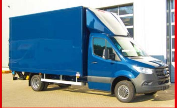
SWK Kofferaufbau mit Dachspoiler und 1000 kg LBW.
