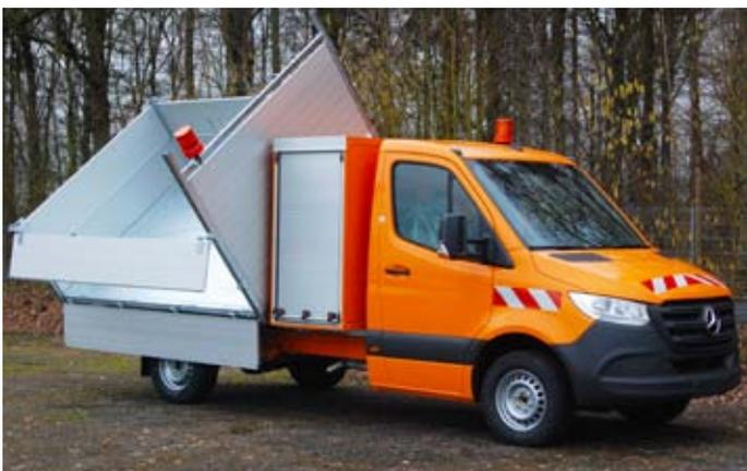
Ausführung mit Pendelaufsatz 400 mm und GFK-Staukasten.
