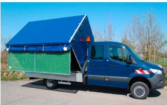
Ausführung mit Plane und Pendelaufsatz mit Gewebeeinheit.
