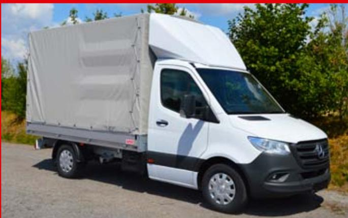
Mittelhochpritsche Typ M mit Plane und Spriegelaufbau.
