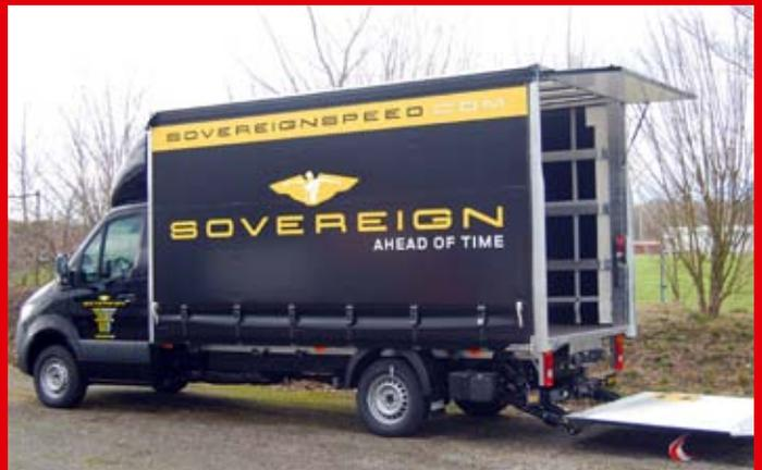
Ausführung mit Schiebepanenaufbau und 750 kg Ladebühne.
