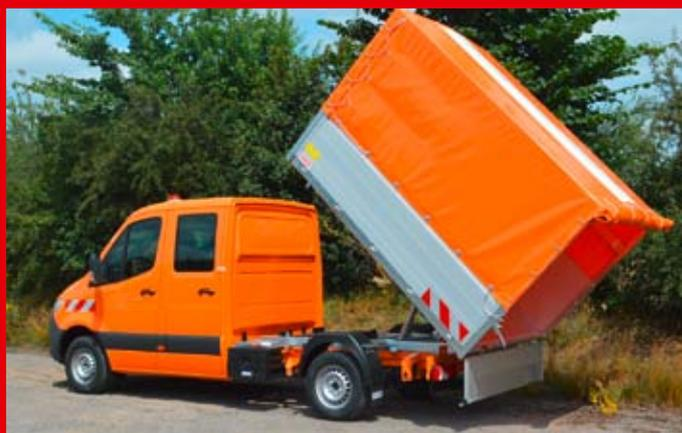
Ausführung mit Planenaufbau und erhöhten Bordwänden.
