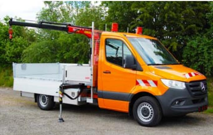
Teleskopkran Fassi M 10 für Lasten bis 995 kg.
