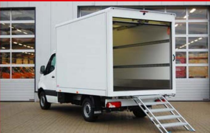
LBK-Sandwichkoffer mit heckseitigem Cargo-Rolltor und Treppe.
