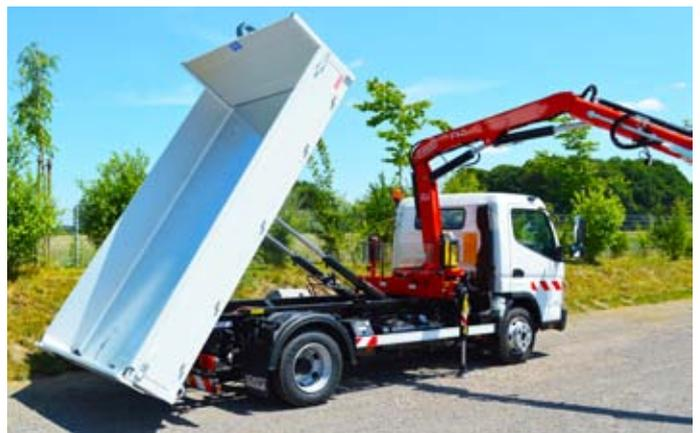
Abrollkipper mit Ladekran und Greiferbetrieb auf Fuso 7C18.
