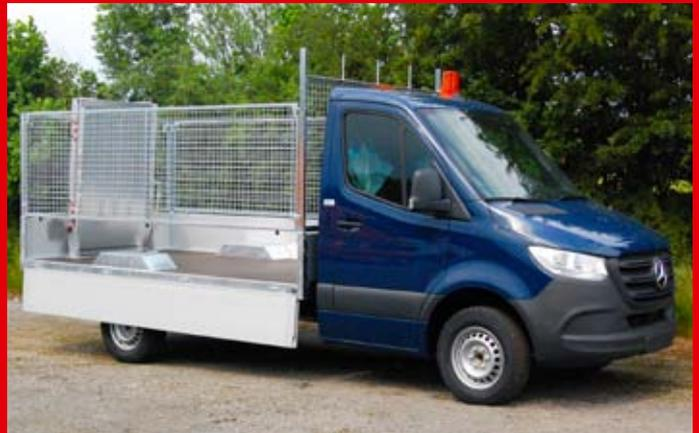
Ausführung mit Stirnwandgitter und 1000 mm Gitteraufsatz.
