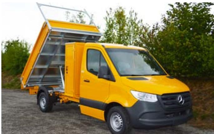
Ausführung mit Materialkasten und Stahlbordwänden, lackiert.
