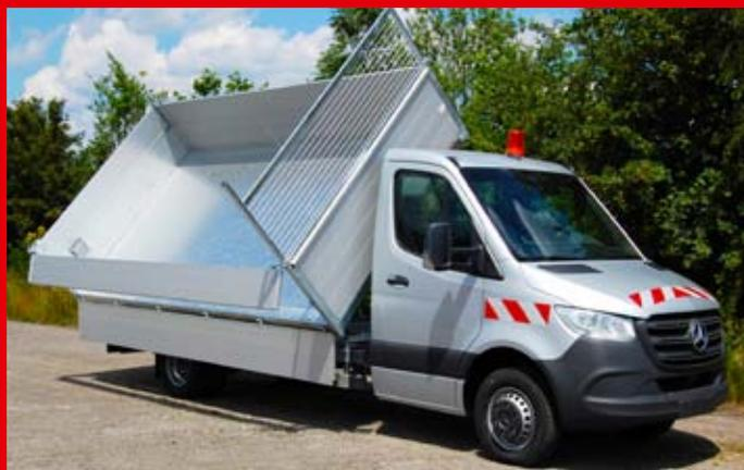
Ausführung mit Aluminium-Pendelaufsatz 300 mm.
