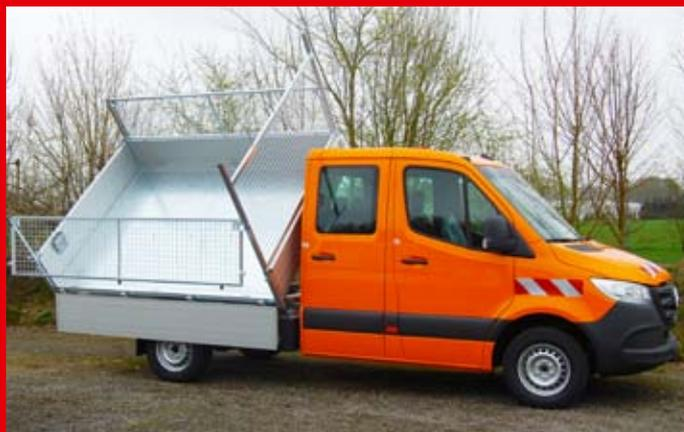
Ausführung mit Stirnwandgitter und Gitteraufsatz 600 mm.
