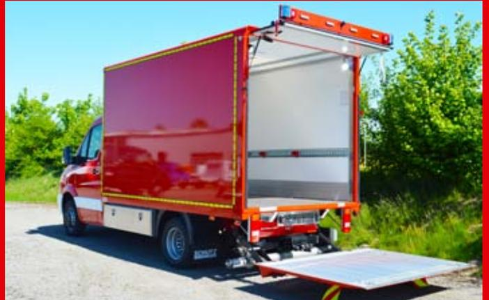
SWK Kofferaufbau als GWL-Feuerwehr Aufbau mit LBW.
