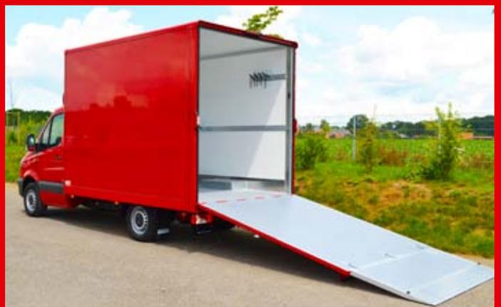
SWK mit doppelt klappbarer Auffahrrampe und Luftfederung.
