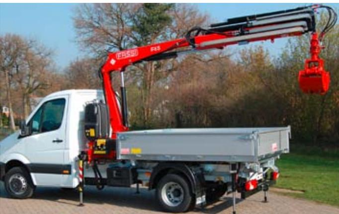
Knickarmkran mit Drehservo und Greiferbetrieb.
