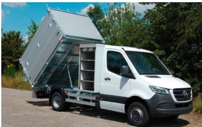
Ausführung mit GFK-Materialkasten und seitlichen Rollos.
