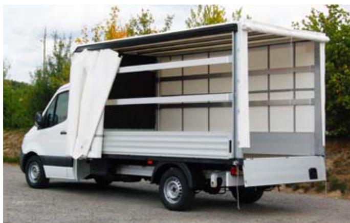
Werkspritsche mit Planengestell und seitlicher Schiebelepane.
