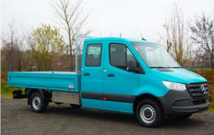
Mittelhochpritsche in lackierter Ausführung mit Alustaukasten.
