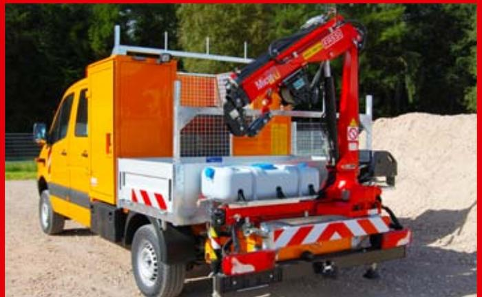
Sonderaufbau mit Heck-Seilwindenkran Fassi Micro 20.
