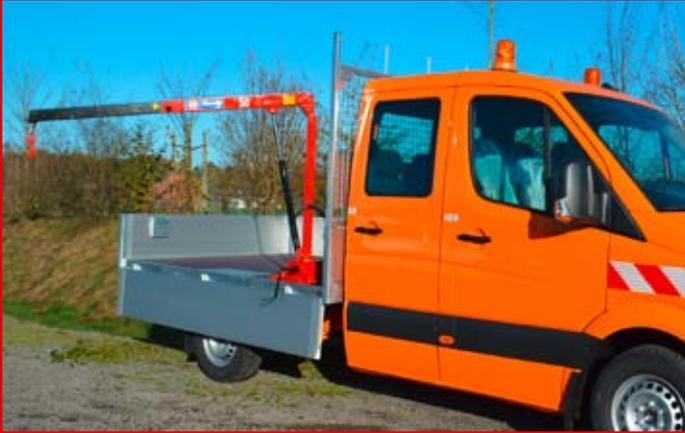
Die kompl. manuelle Lösung. 500 kg mit Handhubzylinder.
