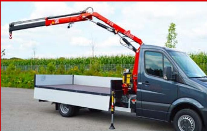
Knickarmkran Fassi F 28 vor Schutz Mittelhochpritsche montiert.
