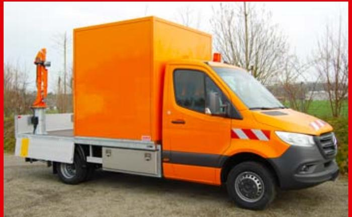
Ausführung mit vorderem Kofferaufbau und Schachtkran.
