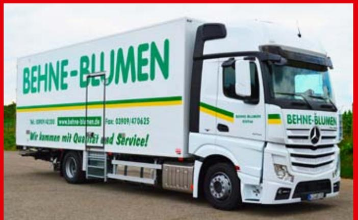
Actros Blumen-Verteilerkoffer mit Kühlung, Heizung und LBW.
