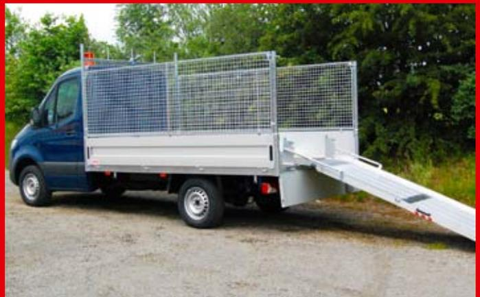
Heckseitig montierte Aluminium 2-fach Klapprampe.
