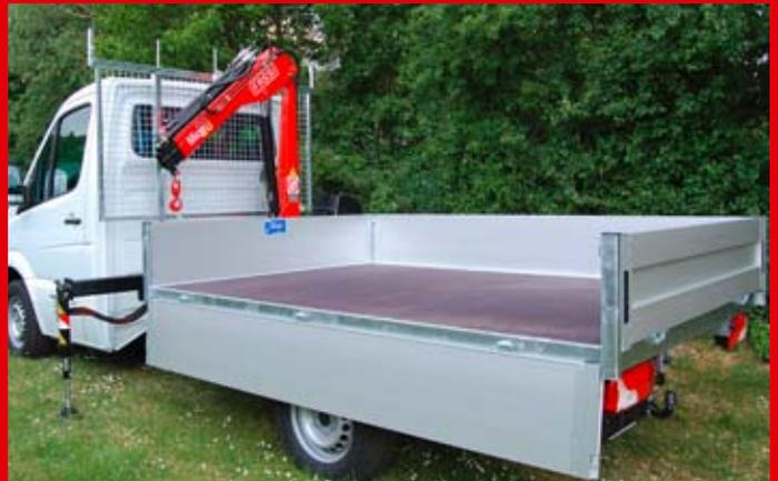
Teleskopkran Fassi M 20 vor Schutz Mittelhochpritsche montiert.
