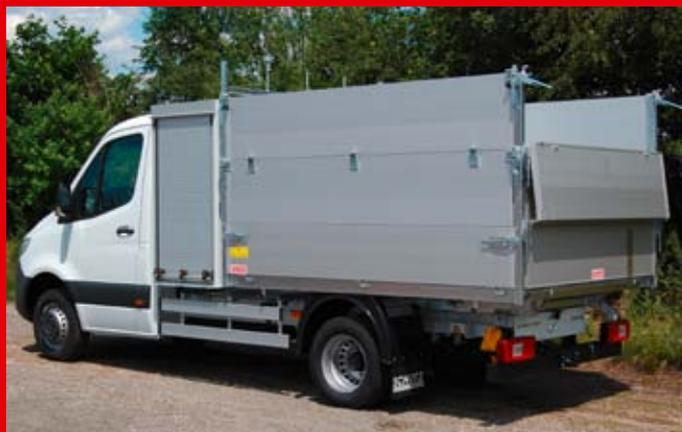
Ausführung mit Aluminium-Aufsatz 2 x 400 mm abklappbar.
