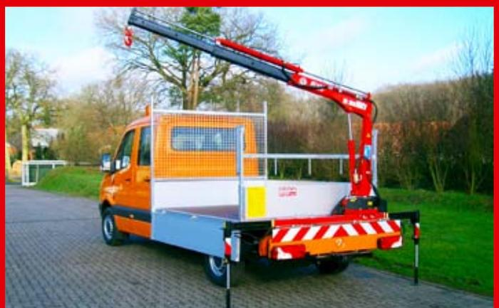
Heckkran 1,5m/to. mit klappbarem Langmaterialträger.
