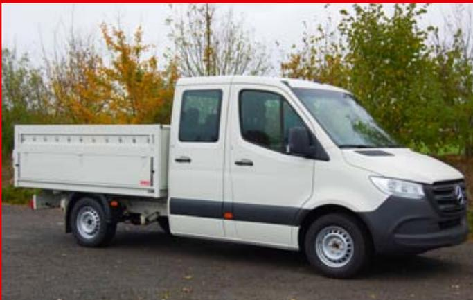
Ausführung mit klappbarem Aluaufsatz 300 mm Höhe.
