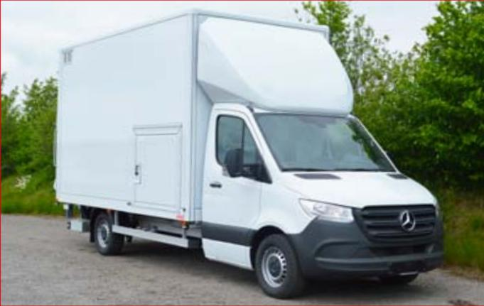
SWK-Sandwichkofferaufbau mit 3-D Dachspoiler und LBW.
