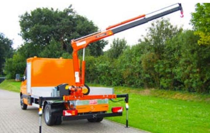
Heckkran 2,3m/to. mit M-Pritsche und Werkzeugschrank.
