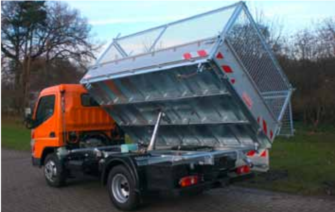
Dreiseitenkipper mit pendelbarem Gitteraufsatz 600 mm
