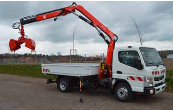
Dreiseitenkipper und Fassi Ladekran F40 mit Greiferbetrieb
