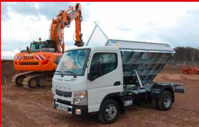
Dreiseitenkipper auf Canter 3S15 nur 1800 mm Aussenbreite!!!
