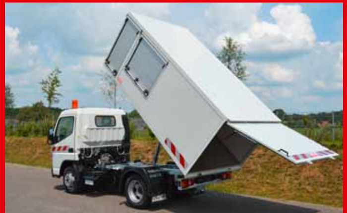
Der ideale City-Entsorger mit leichtem GFK-Aufbau
