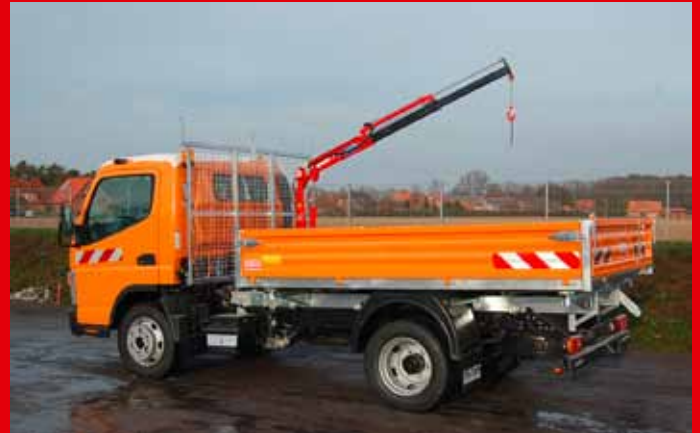
Ausführung mit Stahlbordwände und 500 kg Ladekran
