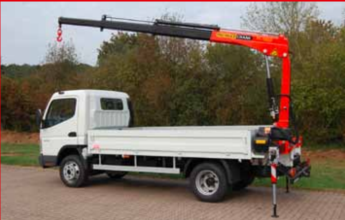
Mittelhochpritsche mit Heckladekran „Palfinger PC 3300“
