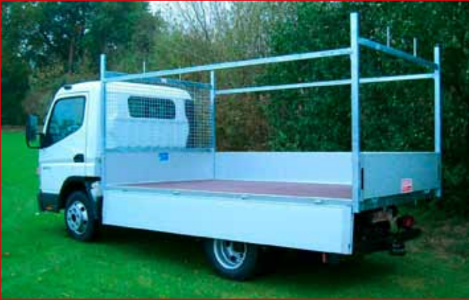
Mittelhochpritsche mit Stirnwandgitter und Langmaterialaufsatz
