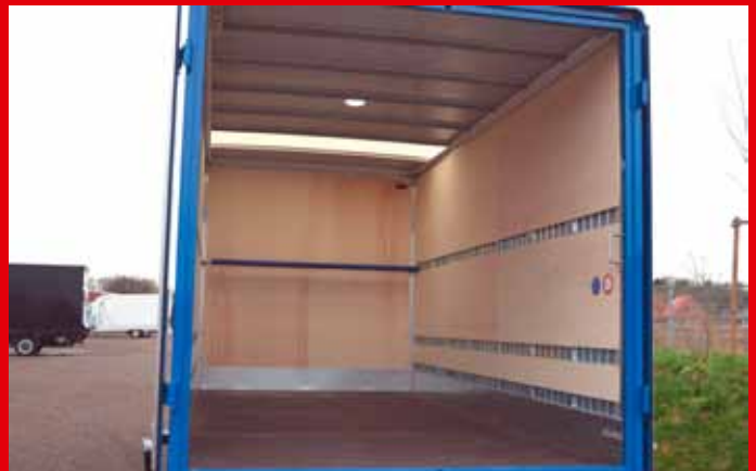
ALK Ausführung mit versenkten Zurrleisten und Holzverkleidung
