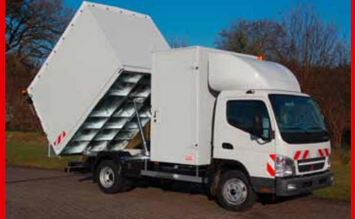
Dreiseitenkipper mit „Häckselaufsatz“ und Werkzeugkoffer vorn
