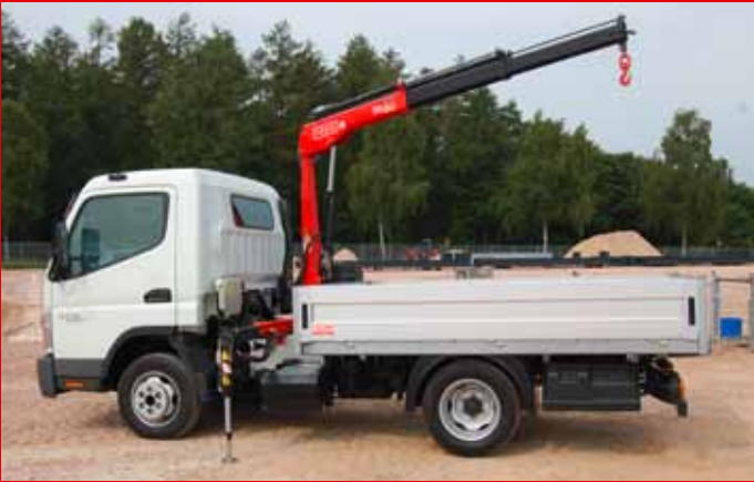
Mittelhochpritsche mit Ladekran „Fassi Micro 20“
