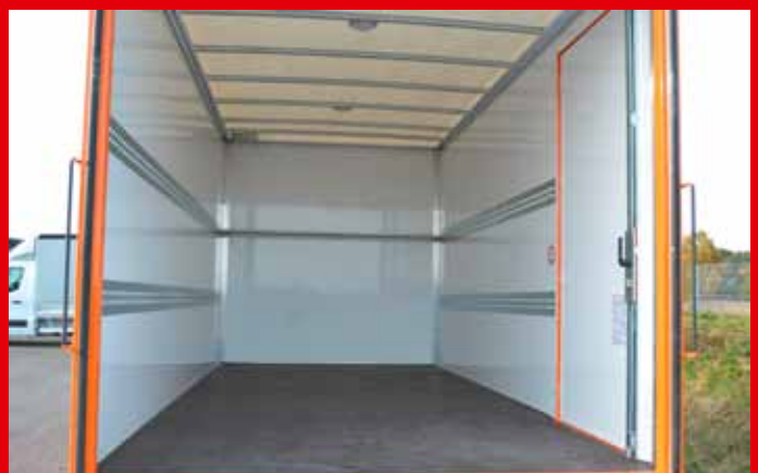
LBK Sandwich-Ausführung mit lichtdurchlässigem GFK-Dach
