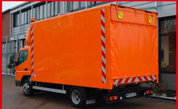
Sonderheck mit Oberklappe, Bordwandklappe und Heckplane
