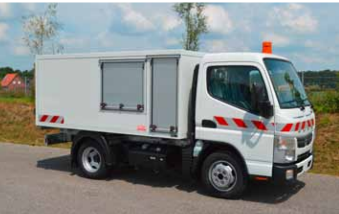
„Müllsammelkipper“ geschlossen Alu/GFK mit Besenschrank
