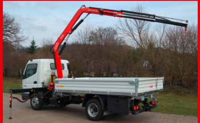
Dreiseitenkipper mit Stahlbordwände und Fassi Ladekran F50
