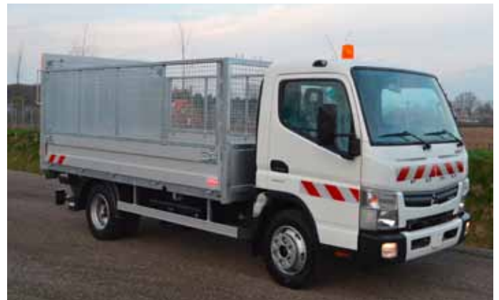
Mittelhochpritsche mit 1000 kg Ladebordwand und Gitteraufsatz
