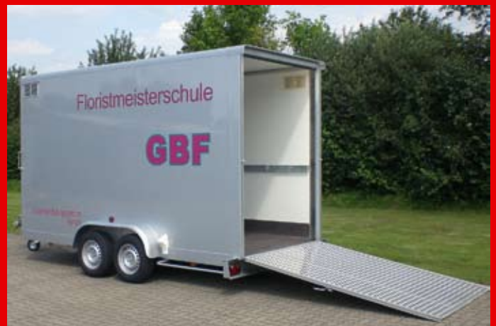
Typ TK 20 D für 6 CC-Container zum Pflanzentransport auch an kalten Tagen.
