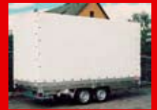
Typ TP 35 mit verstärkter Bordwand oben (Kipperprofil) und klappbare Vorderwand.
