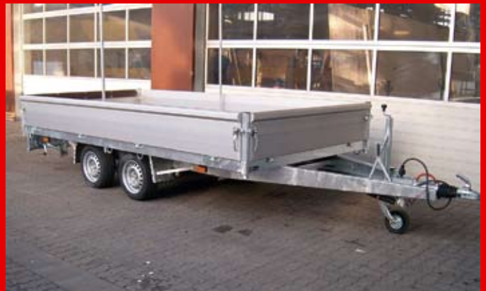
Typ TP 35 mit verstärkter Bordwand oben (Kipperprofil) und klappbare Vorderwand.
