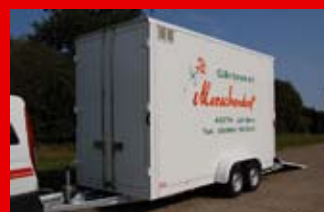
Typ TK 35 D für 9 CC-Container und Durchladesystem zum Zugfahrzeug.
