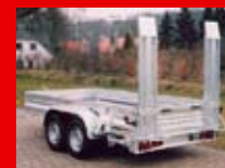
Typ BAS 27 mit klapp- u. seitlich verschiebbaren Aufharrampen sowie Schaufelablage.
