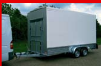
Typ GTA 35 D für 10 CC-Container, Durchladesystem (kl. Rampe vorn) z. Zugfahrzeug
