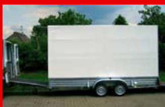
Typ GTA 35 D für 10 CC-Container, Durchladesystem (kl. Rampe vorn) z. Zugfahrzeug
