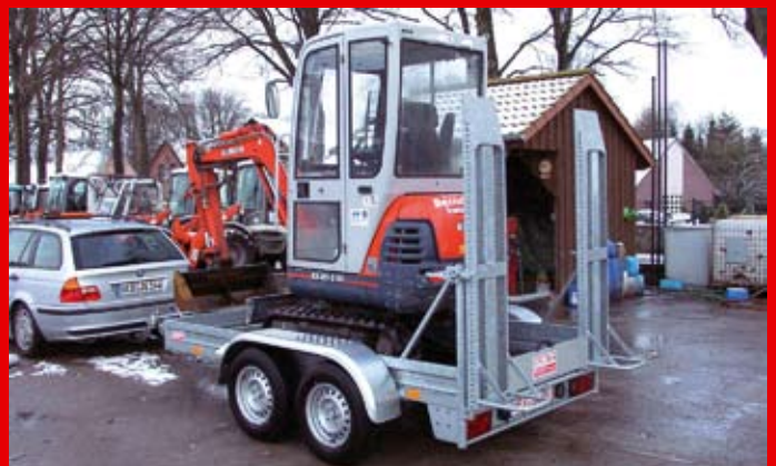
Typ BAS 27 mit klapp- u. seitlich verschiebbaren Aufharrampen sowie Schaufelablage.
