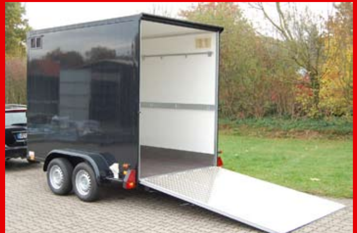
Typ TK 20 D für 6 CC-Container zum Pflanzentransport auch an kalten Tagen.
