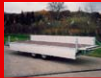
Typ TP 35 mit verstärkter Bordwand oben (Kipperprofil) und klappbare Vorderwand.
