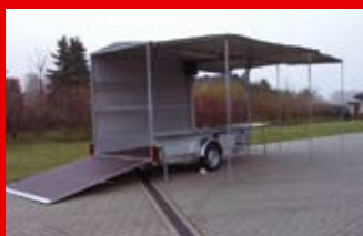
Typ GTA 20 D für 6 CC, Einachsfahrwerk, Verkaufsklappen seitlich, vorn, Planeneinkl.
