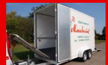
Typ TK 35 D für 9 CC-Container und Durchladesystem zum Zugfahrzeug.
