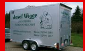
Typ TK 30 D für 9 CC-Container mit den Aerospitzvorbau zum „spritsparen“.
