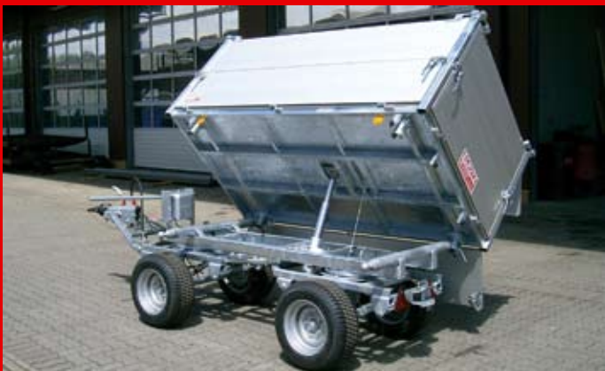
Typ K 18 mit hintere Achsschenkelenkung und Aluminium-Pendelaufsatz (Optionen).
