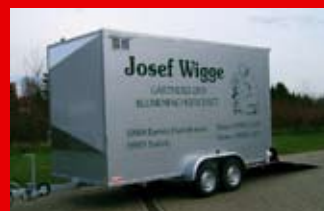
Typ TK 30 D für 9 CC-Container mit den Aerospitzvorbau zum „spritsparen“.
