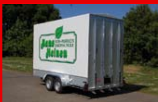
Typ GTA 30 D für 9 CC-Container und Innenhöhe 2600 mm (Option)
